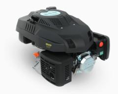
El modelo MVNW-201 pertenece a la línea de motores verticales nafteros, monocilíndrico, 4 tiempos, de la marca Niwa. Se destaca por su fácil arranque y bajo consumo de combustible. Sus características: 6.5 HP / 201 CC, válvulas a la cabeza (OVH) y un gran filtro de aire. Apto para 22" / 55,8 cm de corte. Ideal para motorizar nuestras cortadoras de césped Pampa Pro y otras similares. Mantenimiento de jardines y espacios verdes amplios.
